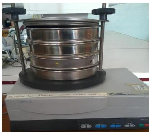
**Fig III.1 .** Appareil de tamiseur
