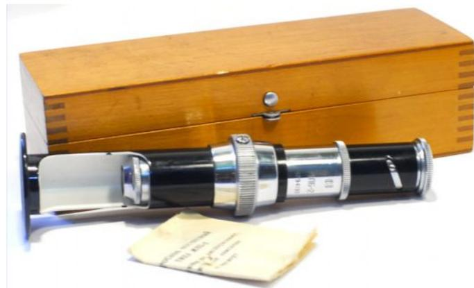
Figure II.16. Microscope optique Magnit 24<sup>x</sup> MPB-2.
