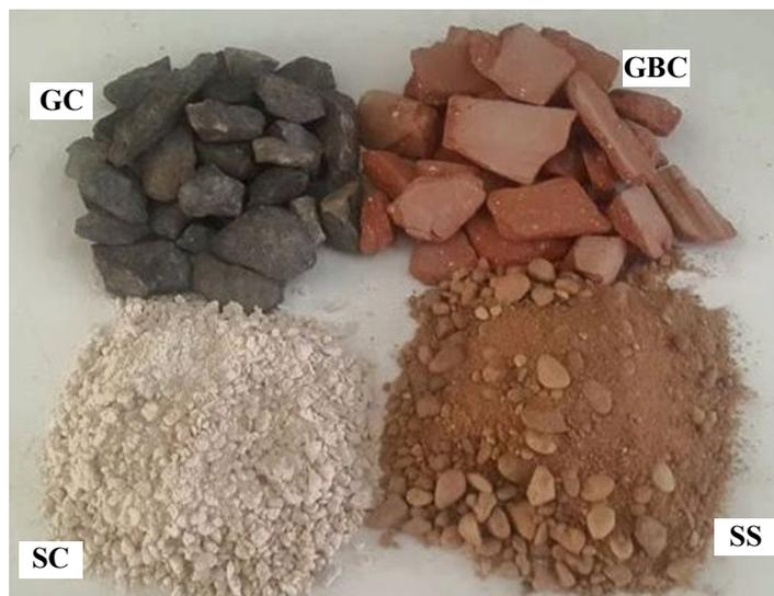
**Figure II.1.** Différents granulats utilisés, GC: granulats calcaires, GBC: granulats de brique concassée, SS : sable siliceux, SC : sable calcaire.
