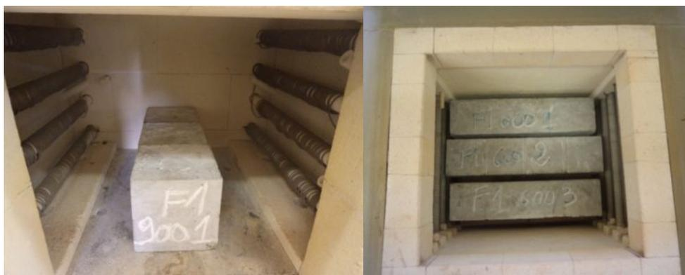
Figure II.8. Disposition des éprouvettes dans les fours.
