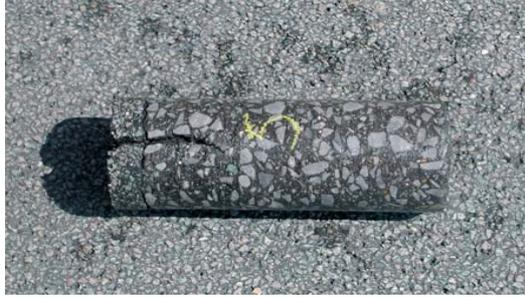
**FIGURE I.27:** Carotte prélevée au droit d'une fissure
