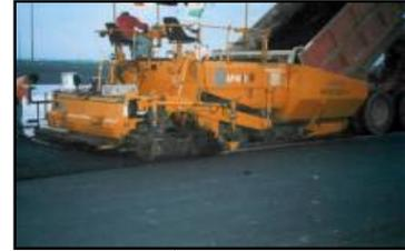
Basculement de béton bitumineux installé dans chargeuse sur chenilles.
