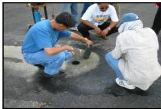
Extraction complète de carotte montrant Biding de PGMG de revêtement En asphalte et la couche de liaison.
