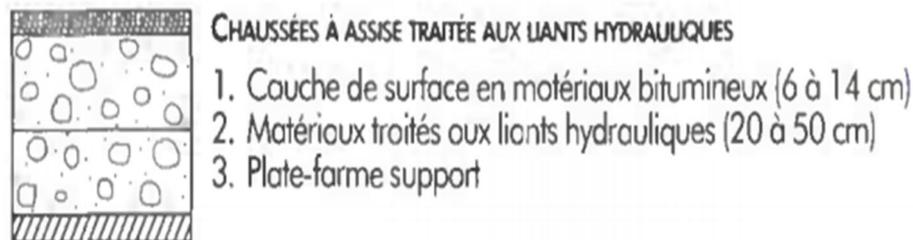
Fig. I.4: Les chaussées à assise traitée aux liants hydrauliques
