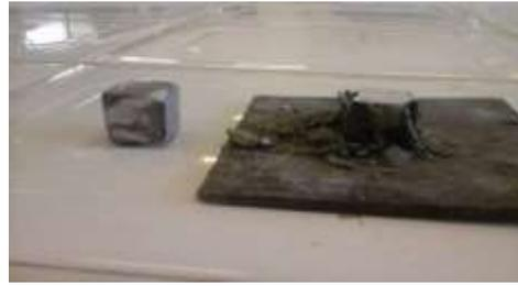
**Figure IV.25 :** L'éprouvette du laitier après l'écrasement
