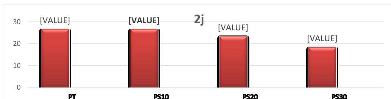
**Figure V.01 :** Evolution de RC en fonction de % du laitier en 2 j
