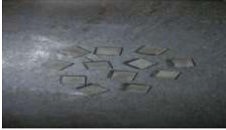
**Figure IV.24 :** L'éprouvette du laitier avant l'écrasement
