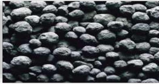
**Figure I-9 :** Nodules de clinker de taille environ 20 mm
