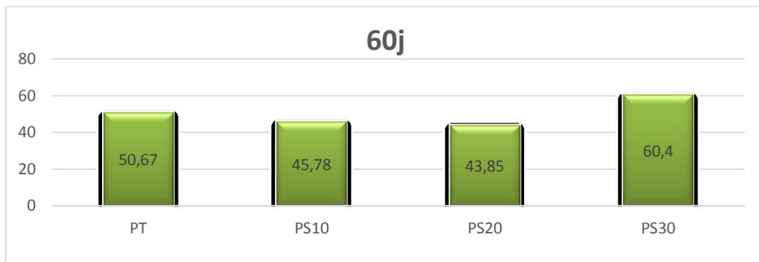
Figure V.05 : Evolution de RC en fonction de % du laitier en 60 j
