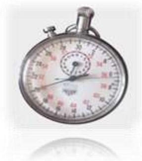
**Figure IV.03 :** Chronomètre précis à 0.2s
