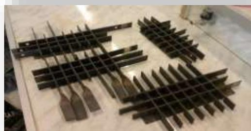
**Figure IV.23: Les moules utiliser 2\*2\*2 cm**
