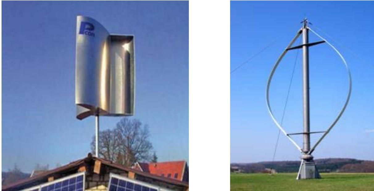
Figure I.7:Éolienne types Savonius (à droite) et de type Darrieus (à gauche)
