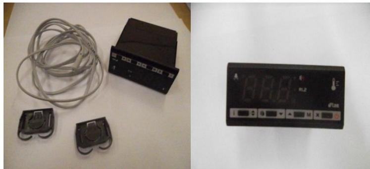
**Fig. 4.14.** Thermorégulateur avec une sonde du type K.
