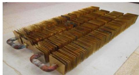
Fig. 4.18. Condenseur avec ailettes en cuivre.
