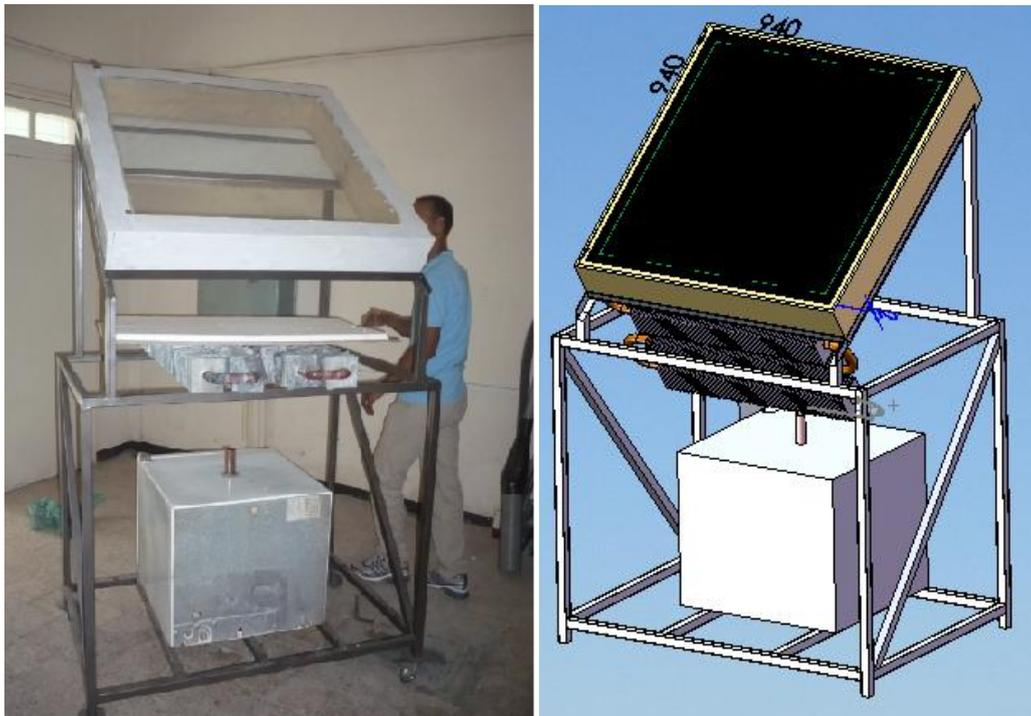
**Fig.3.1.** Le réfrigérateur à adsorption réalisé par Nesba et Hassen [6].
