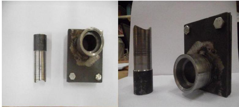
**Fig. 4.19.** Dispositif spécial pour trouser les éilettes.
