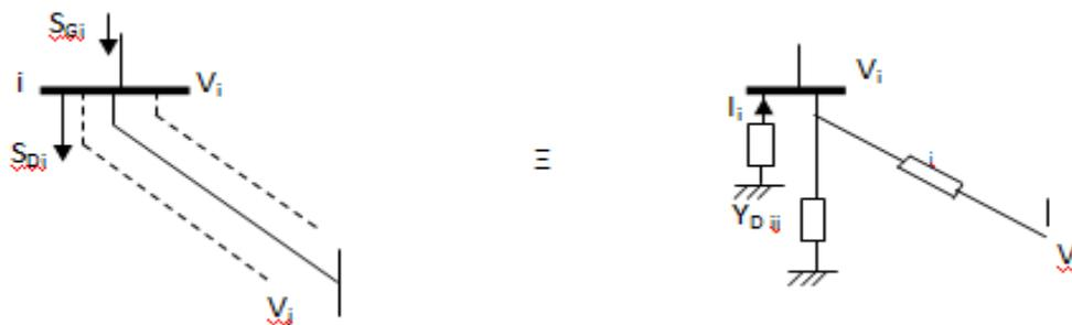
Figure (I- 1): Formulation de l'équation de l'écoulement de puissance.
