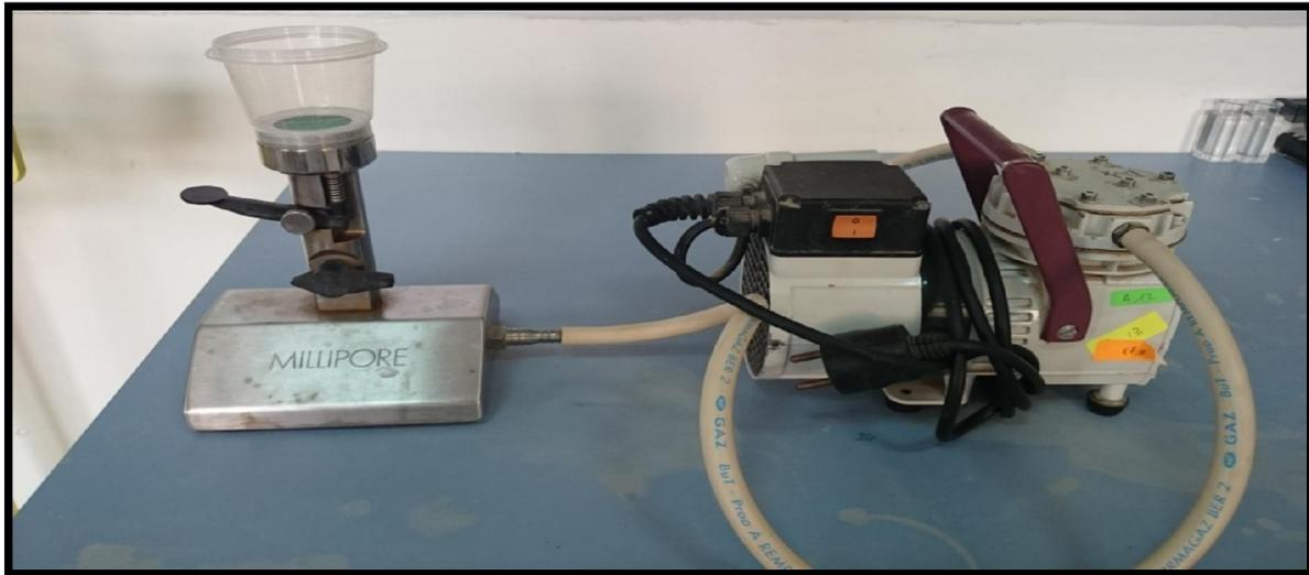
**Figure.III.15.** Dispositif de filtration.
