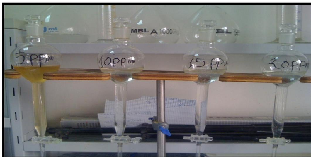
**Figure.III.17.** l'extraction liquide-liquide par l'hexane.
