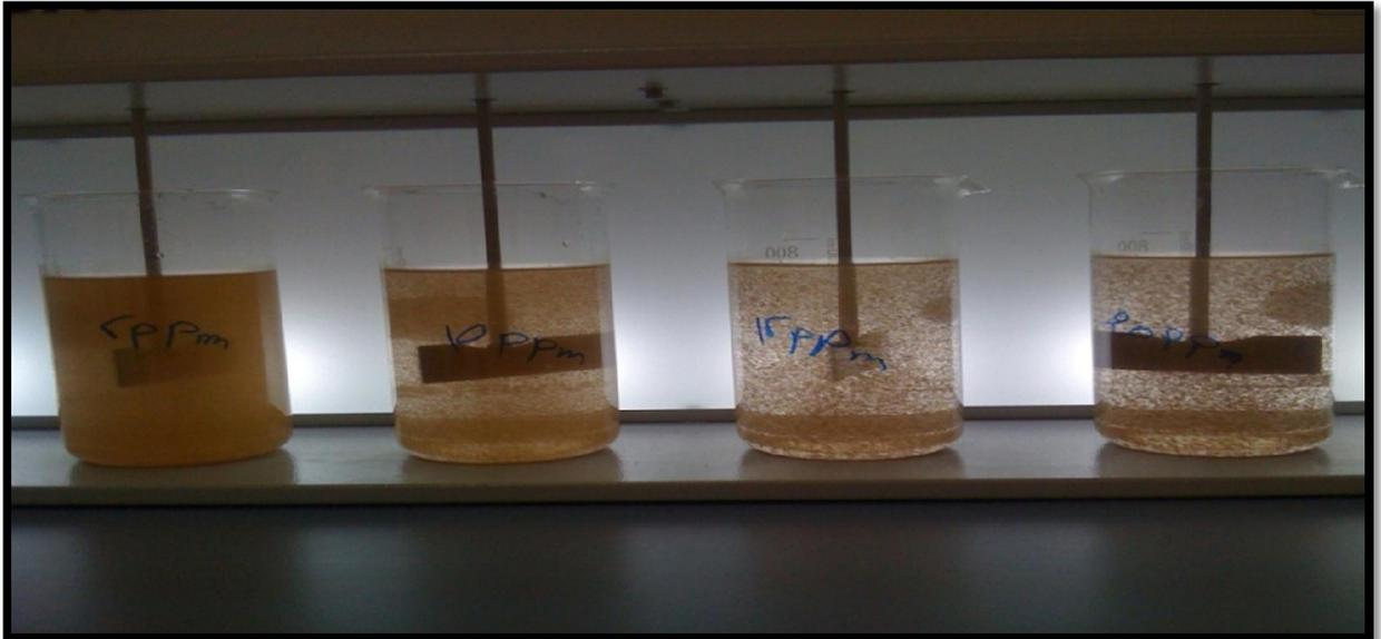
Figure.III.8. Les échantillons après injection du coagulant et en agitation.
