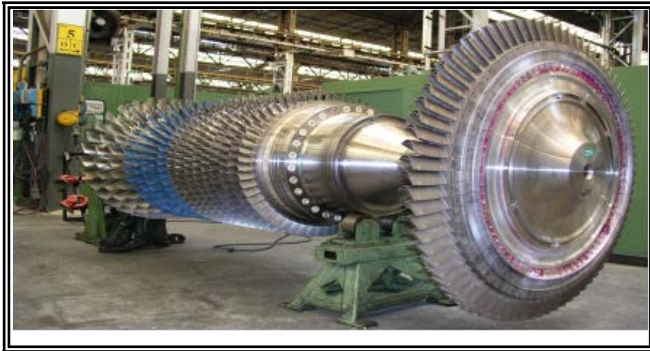
Fig.II.4.a Vue d'ensemble rotor de turbine HP à compresseur (MS5002b)
