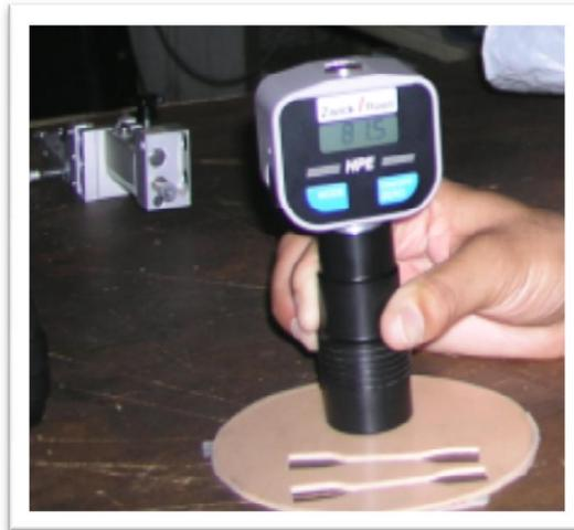
Figure IV.7 : Appareil de type Zuick/Roell mesure la dureté Shore A.
