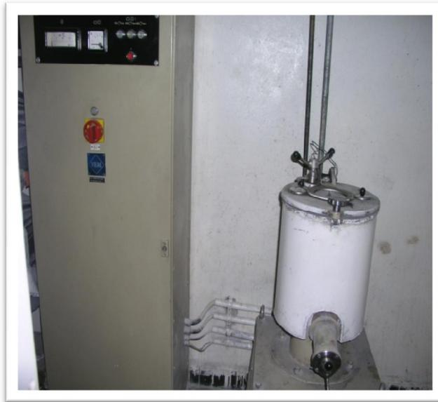
Figure IV.2 : Mélangeur de type MSH25.
