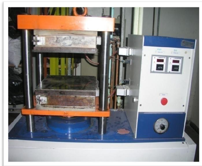
Figure IV.4 : Presse de type polystat.
