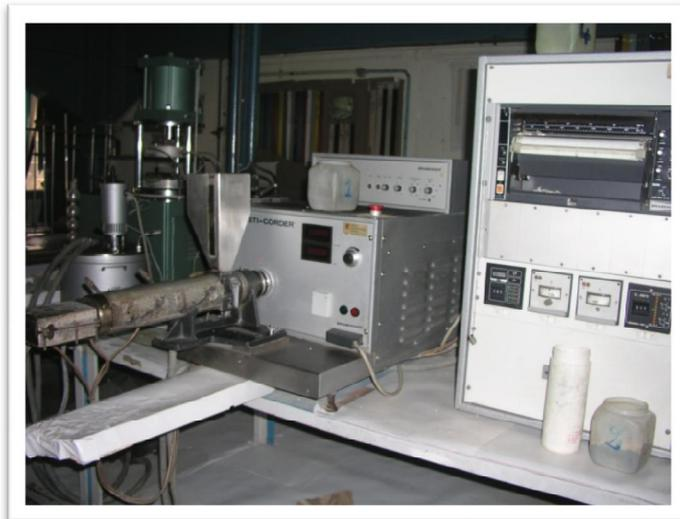
Figure IV.3 : Extrudeuse de type plasti-corder type PLE330.
