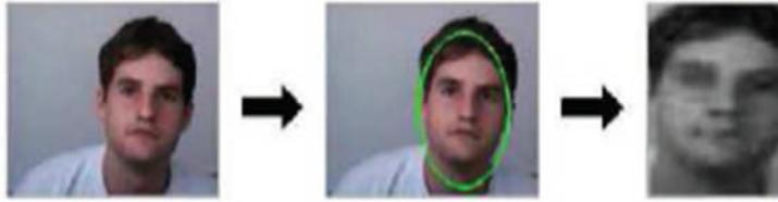
**Figure 1.13** – Détection et normalisation des visages proposées par Gourier
