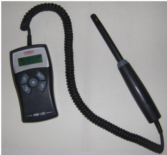
**Figure (III-6) :** Hygromètre de type Kim pour mesurer l'humidité relative et la température de l'air
