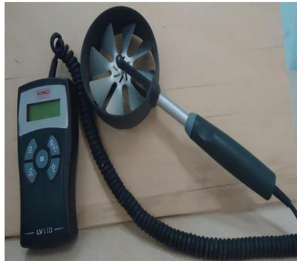
**Figure (III-7) :** Anémomètre à hélice de type Kimo pour mesurer la vitesse de et la température de l'air
