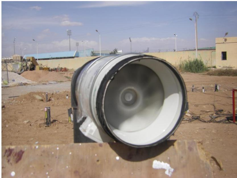
**Figure (III-4) :** Extracteur d'air utilisé pour le pompage de l'air
