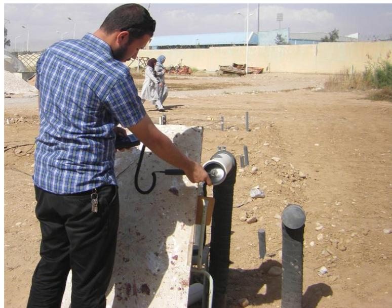
**Figure (III-9) :** mesure de la vitesse de l'air à la sortie de l'échangeur par anémomètre à hélice de type KIMO LV 110.
