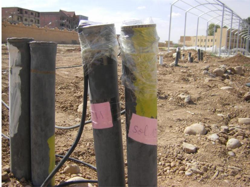
**Figure (III-5) :** sondes de mesure de la température de l'air en circulation à travers l'échangeur et dans le sol
