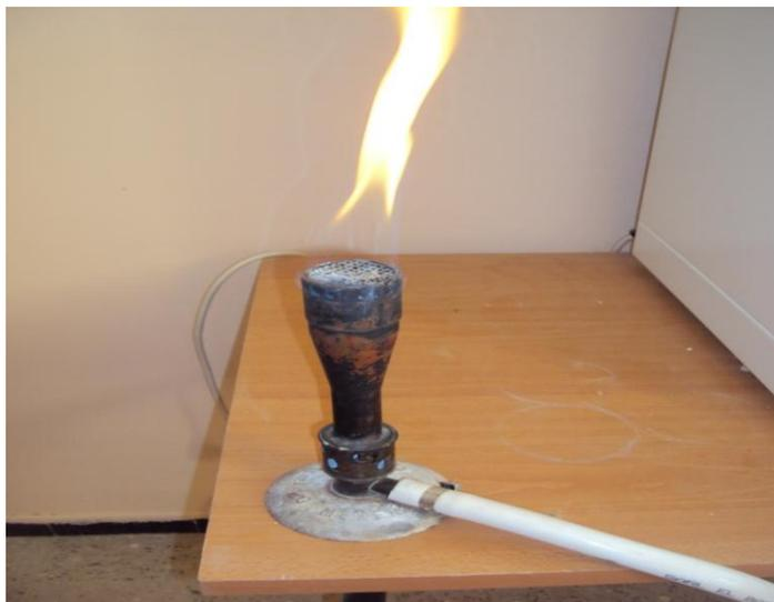
**Fig II-2 : Bec benzène à  $800^{\circ}\text{C}$ .**
