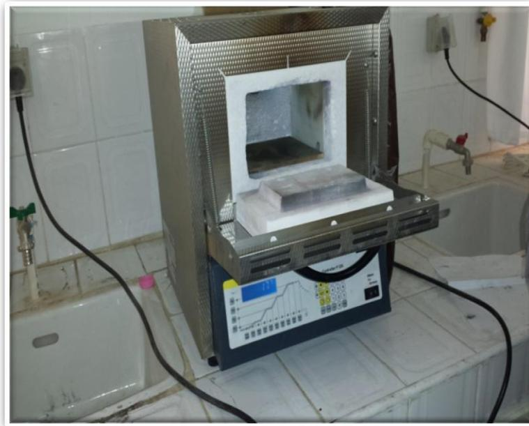
**Figure II.3: un four à convection électrique**
