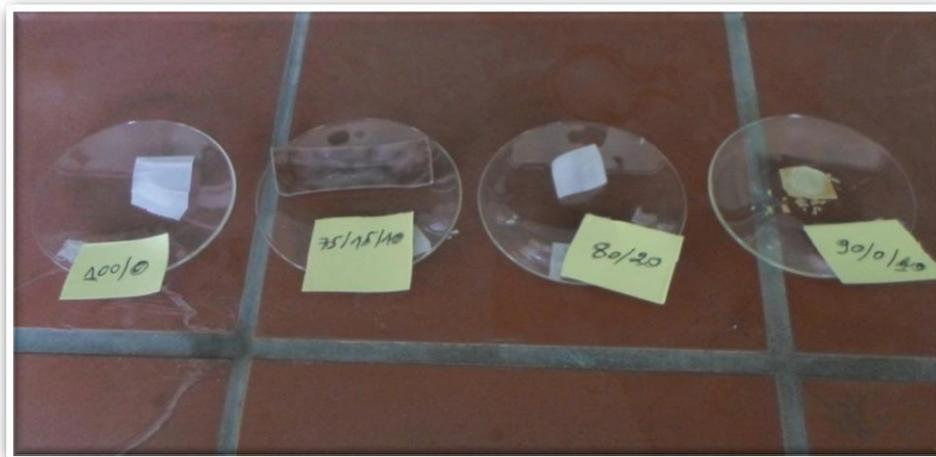
**Figure (III. 3) :**Constatations visuelles des compositions après traitement thermique (4 jours à 80°C)
