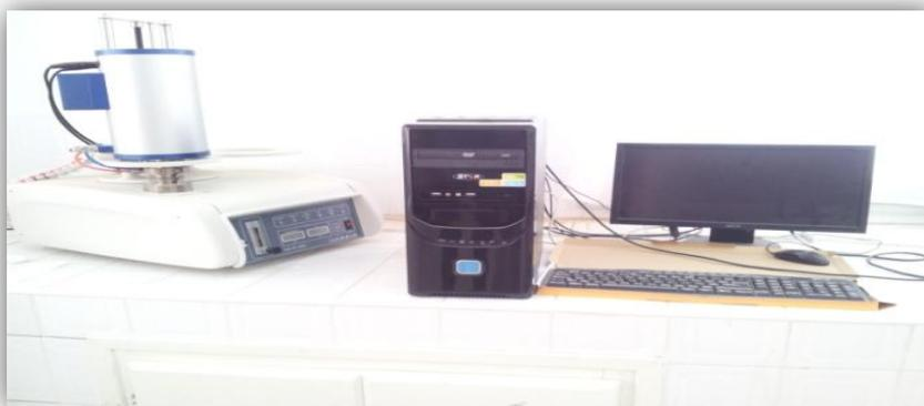
**Fig.III.09** : L'appareil de l'Analyse thermique (Dispositif ATD-ATG couplé (Lynseis 2400)).
