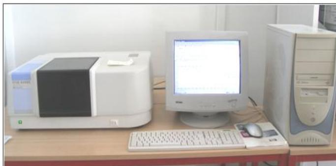
**Fig.III.10:**l'appareil de l'Infrarouge
