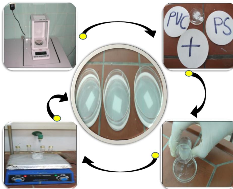
Fig.III.05: Les étapes de la préparation d'un film du mélange : PS / PVC.
