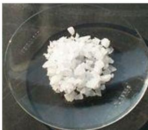
**Fig.III.03:** le sulfate d'aluminium (Alun).
