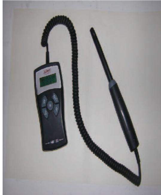
Anémomètre : mesure de la vitesse du vent et l'humidité
