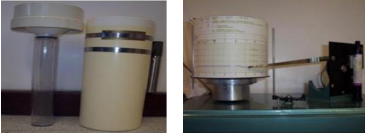
Figure 20 : un pluviomètre (a) et un pluviographe (b)
