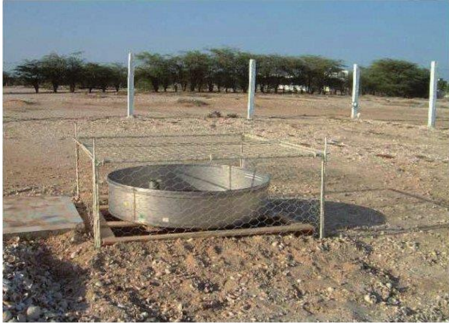
Figure 17 : Bac d'évaporation Classe A installé sur terrain
