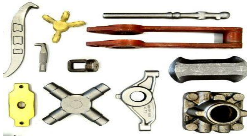
Figure VI.3.: Exemples des pièces obtenues par le procédé de forgeage chaud
