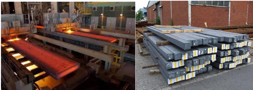
Figure 2 : Billettes produites par le procédé de coulée continue.
