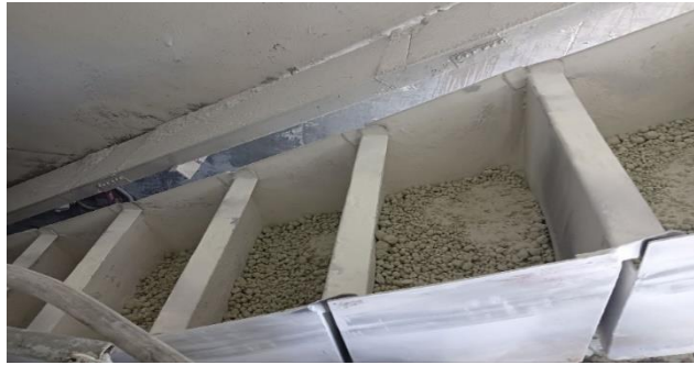
Figure I.16 : Clinker après refroidissement
