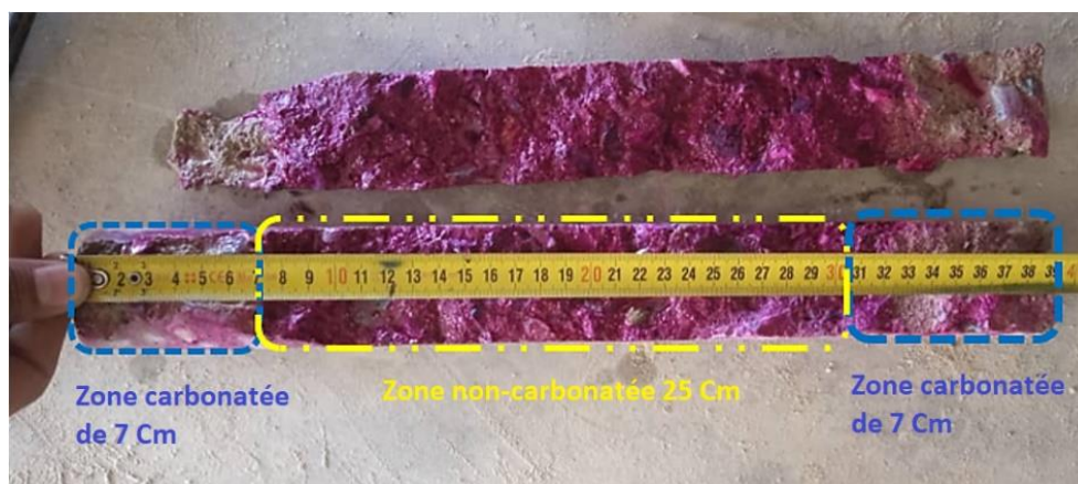
Figure I. 3 : Profondeur de béton carbonaté d'une éprouvette.
