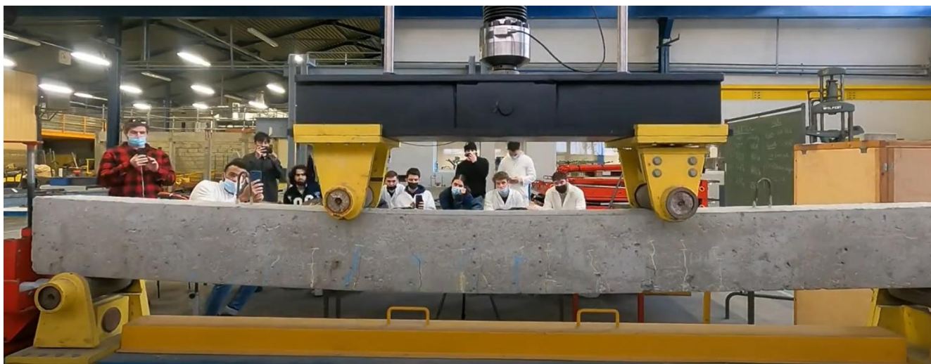
Figure IV. 26 : Essai expérimental d'une flexion d'une poutre en béton armé « flexion à 4 points ».
