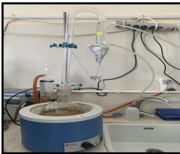
Figure 08: Appareil de type Clevenger utilisé pour extraire les huiles essentielles des graines de B.incrassatum (Saadaoui and Saadi, 2023) .
