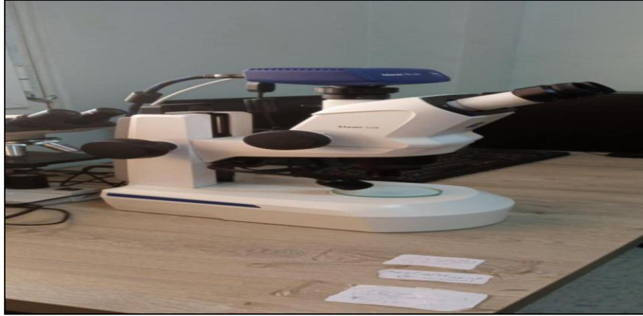
Figure 23. Un stéréo - microscope trinoculaire avec caméra utilisée pour l'observation des génitalia (Originale, 2025).
