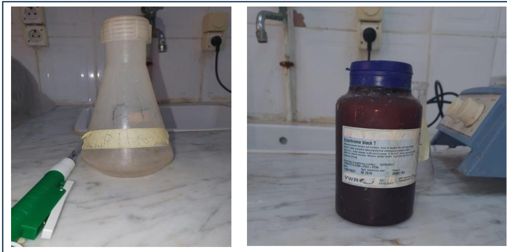
Figure 11: tampon à ph 10 et indicateur NET (photo prise par Ikram)
