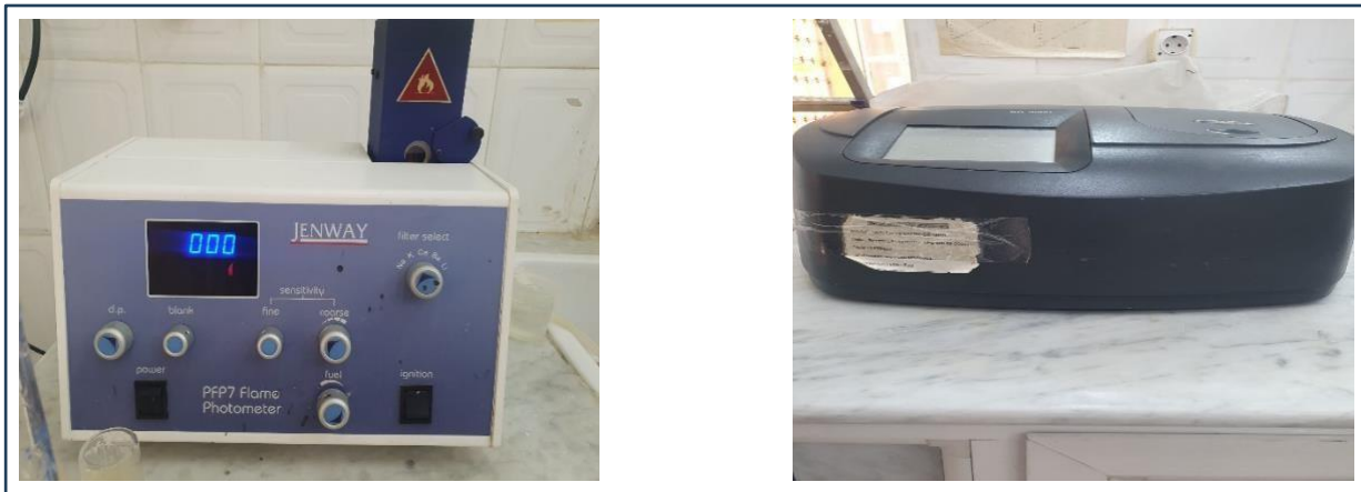
Figure 8: les appareils utilisés: photomètre à la flamme, spectrophotométrie. (photo prise par Ikram)
