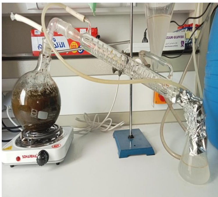
Figure 6: Appareil de type Clevenger utilisé pour l'hydrodistillation.
