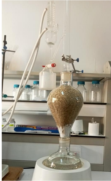
Figure 7: Appareil de type Clevenger utilisé pour l'entraînement à la vapeur.
