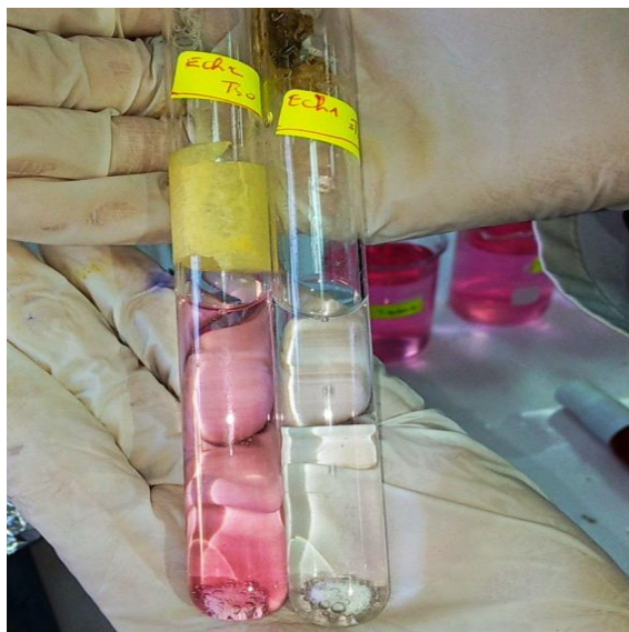
Figure 8. Détection du chlore libre dans l'eau par la méthode DPD (original).
