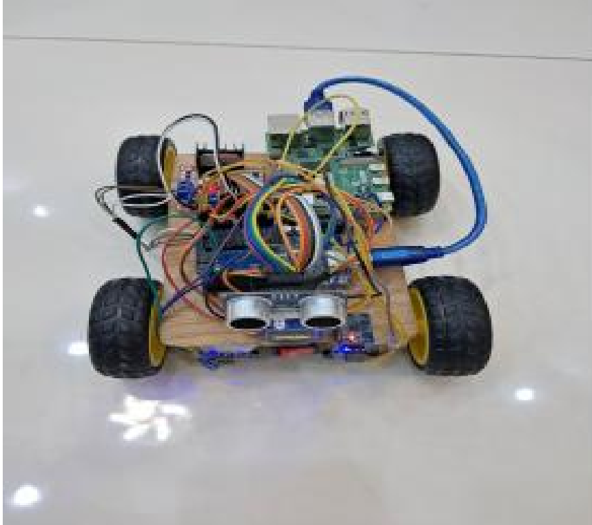
الشكل (5.1): الصورة الحقيقية للروبوت المجهز بالحساسات ووحدات التحكم.
