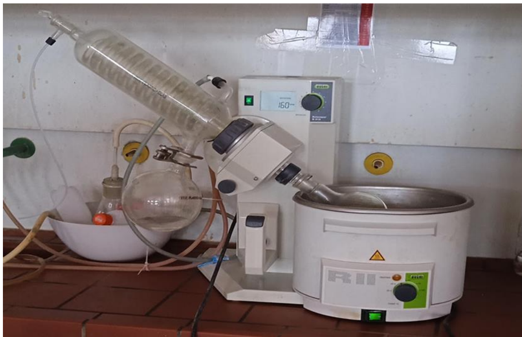
Figure III-10 : L'évaporateur rotatif pour éliminer les solvants organiques.
