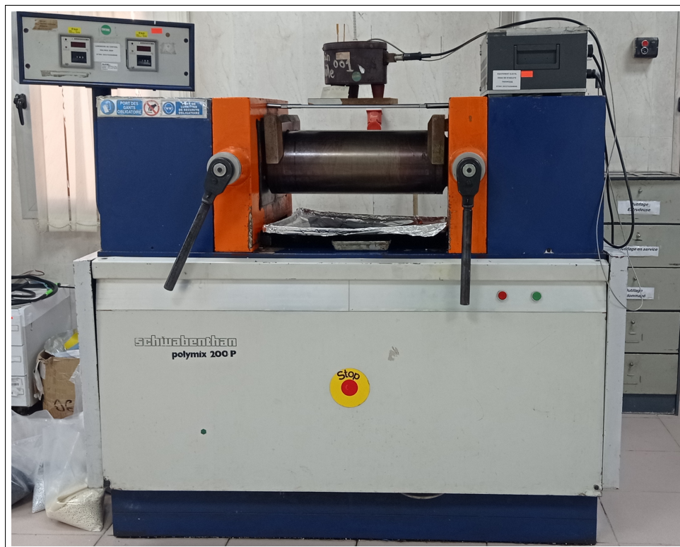
FIGURE III.4 Calandrage utilisés dans la préparation des composites.
