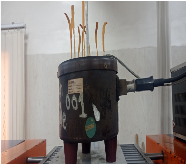
FIGURE III.16 Dispositif expérimental pour test de stabilité thermique.
