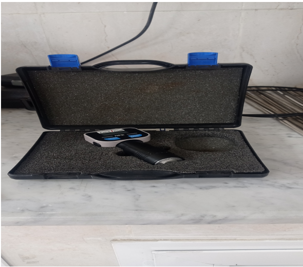
FIGURE III.14 l'appareil servant à mesurer la dureté shore A.
