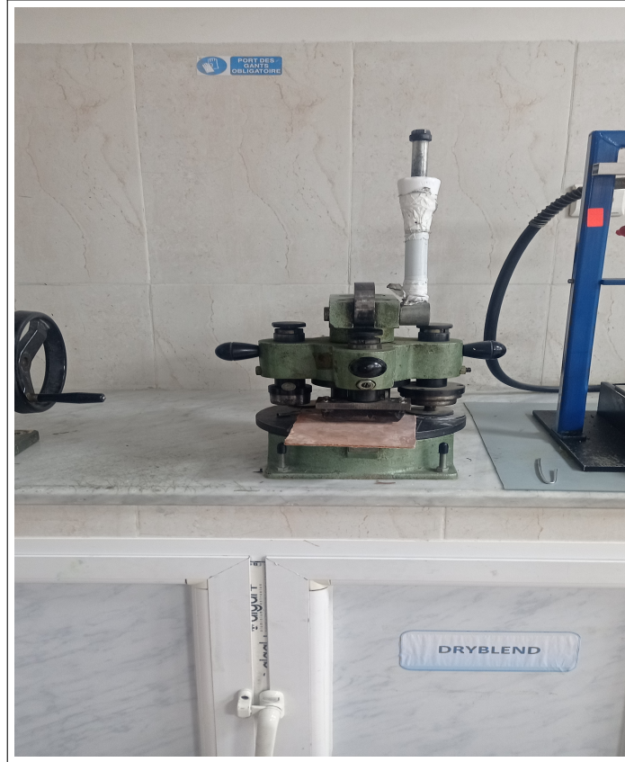
FIGURE III.8 Le découpage des plaques sous forme d'haltères par la découpeuse.
