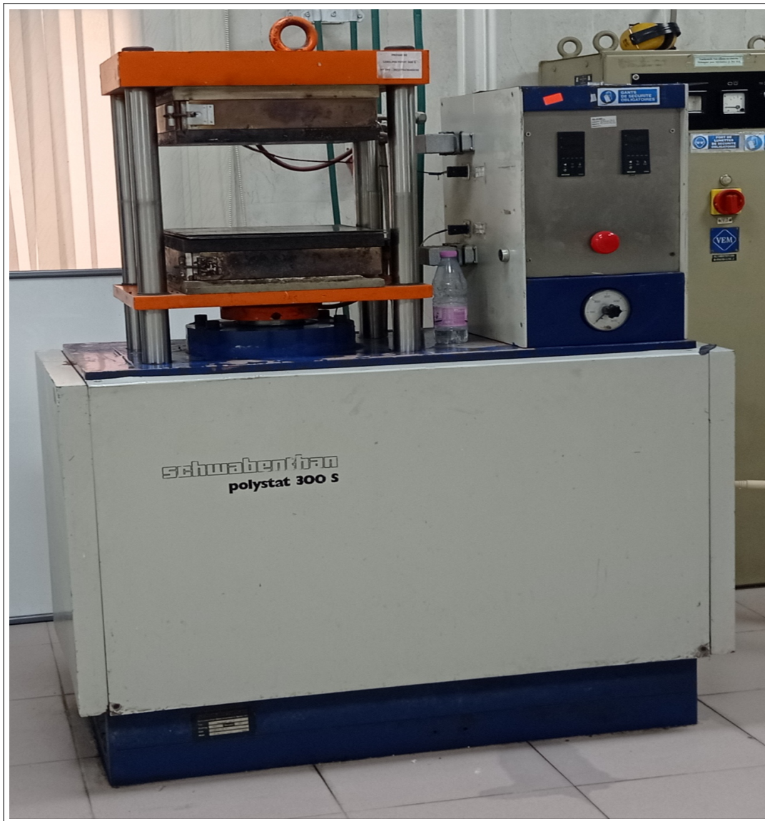
FIGURE III.6 La presse utilisée pour la préparation des plaques.
