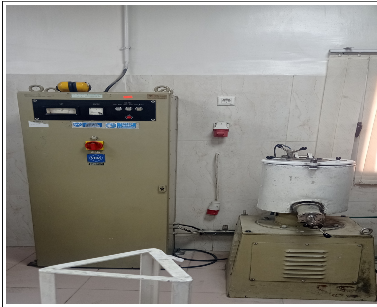
FIGURE III.10 Mélangeur à hélices pour poudres sèches (dry blender).
