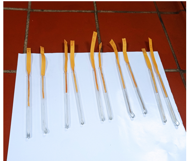
FIGURE III.16 Dispositif expérimental pour test de stabilité thermique.
