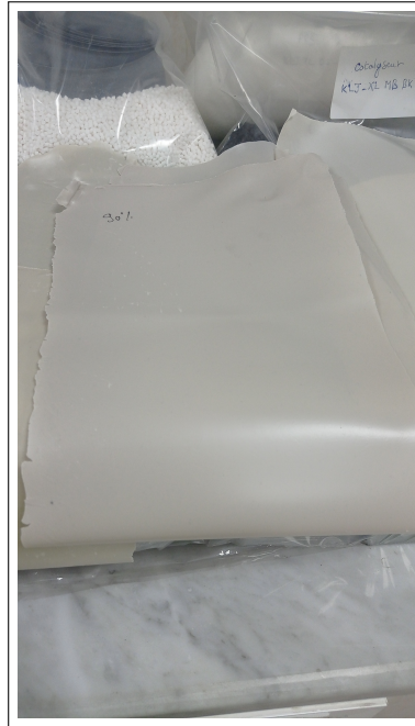
FIGURE III.5 Le film du composite obtenu par la calandre.
