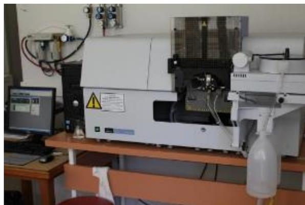
**Figure III.10:** Spectrophotométrie d'absorption atomique
