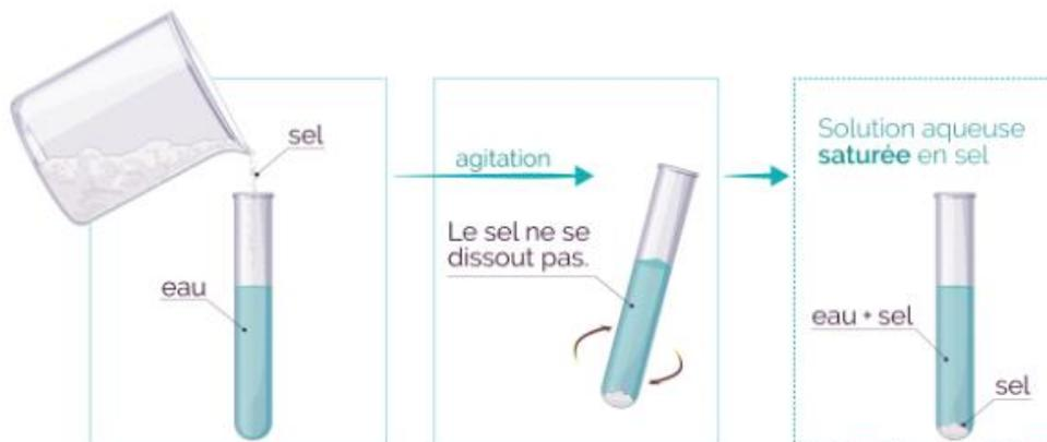
Figure I.8: Saturation de l'eau en sel
