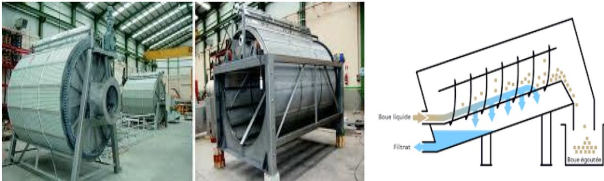
**Figure IV.6 :** Schéma d'un Micro-tamis à tambour
