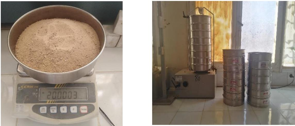
*Figure 2.2 Analyse granulométrique.*
