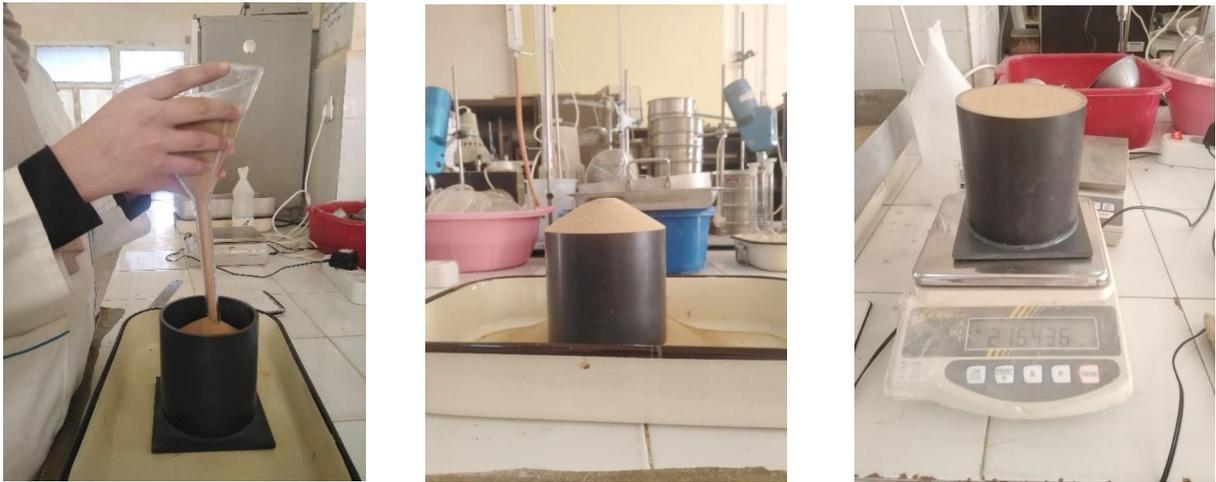
**Figure 2.4** Détermination de l'indice de vides ( $e_{max}$ )
