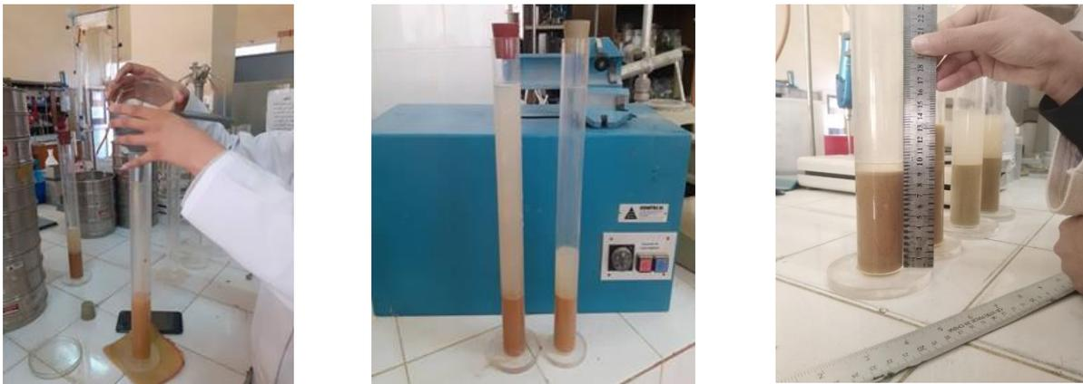
*Figure 2.7* L'équivalent de sable
