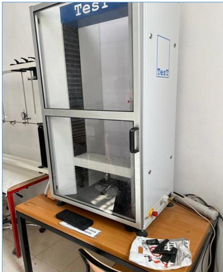
*Figure 4.1* : Machine universelle de type TEST.
