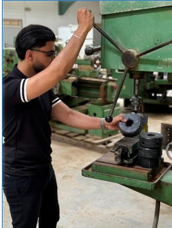
*Figure 3.11* : Perçage Précis des Nœuds pour une Installation Optimale des Supports.
