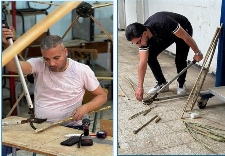
**Figure 3.10** : Coupées à des longueurs mesurées.
