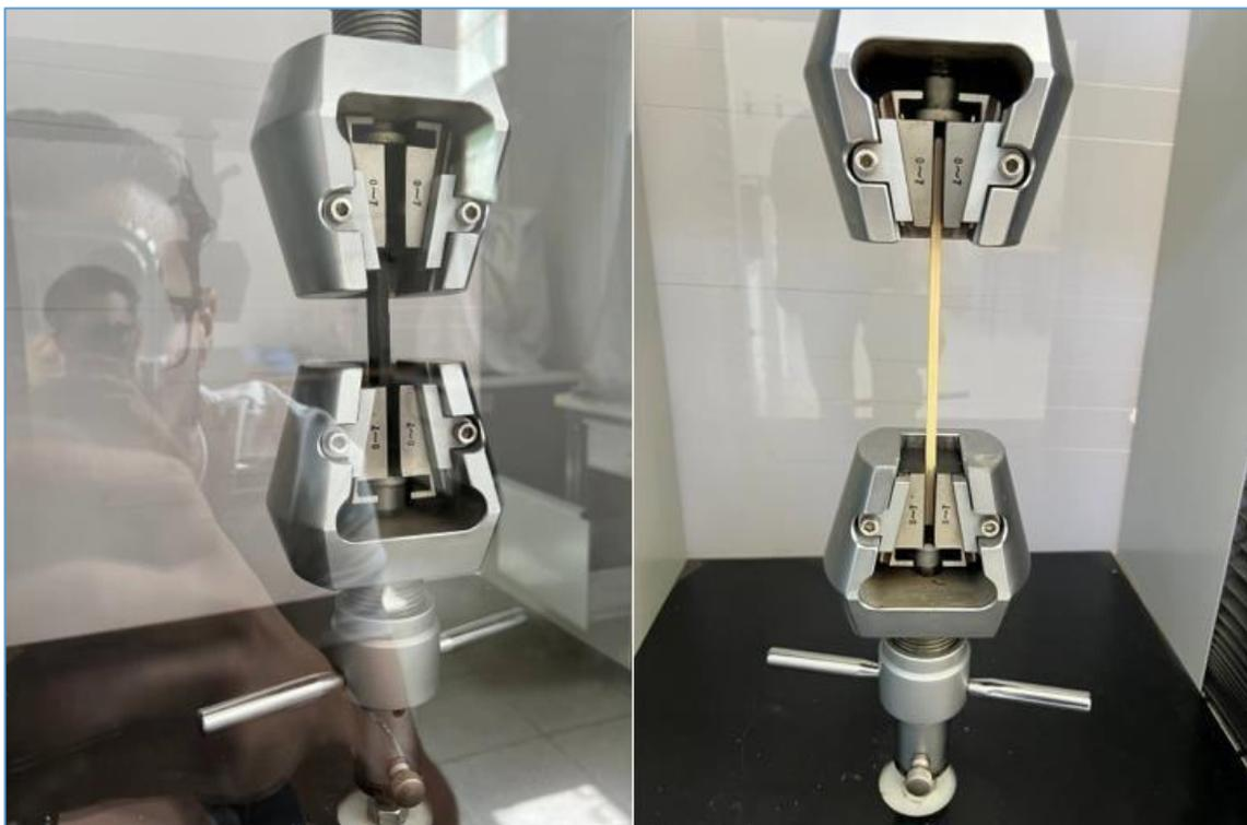
*Figure 4.2* : Test de traction du bois de rachis et plastiques recyclé.
