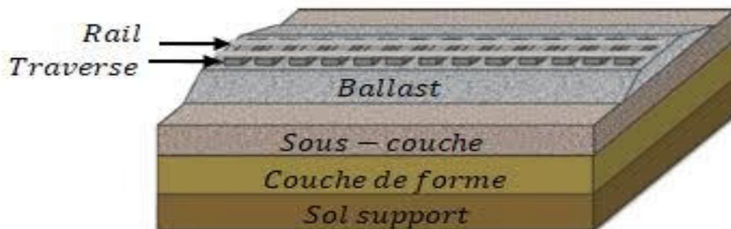
**Figure 1.02 :** les couches de la voie ferrée.
