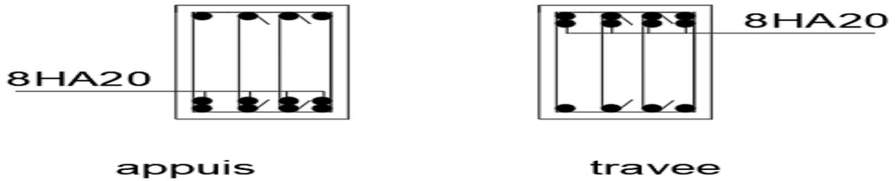
Figure 6.7 : Schéma de ferrailage de la nervure en travée et en appui
