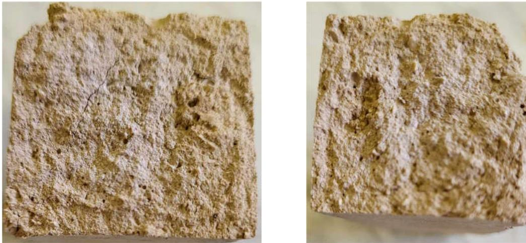
**Figure 3.9** Coupes transversales des échantillons montrant un précipité blanchâtre sur les sections internes.
