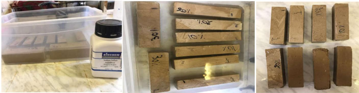
**Figure 2.17** : Essai d'attaque externe au sulfate.
