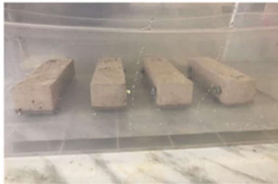
**Figure 2.13:** Essai d'absorption par capillaire.
