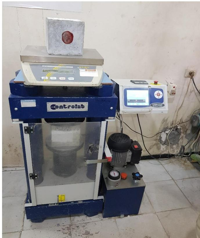
**Figure 30 : Presse à Béton**
