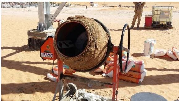
**Figure 6 : Bétonnière pour la production à petit quantité**
