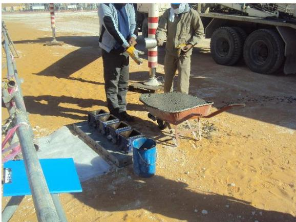
**Figure 27 : Prélèvement des Echantillons**
