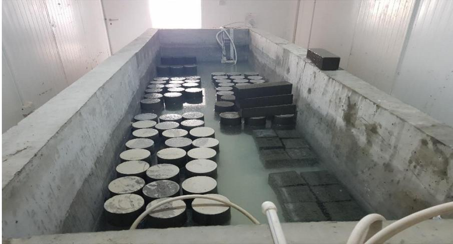
**Figure 29 : Bassin pour la conservation des éprouvettes**
