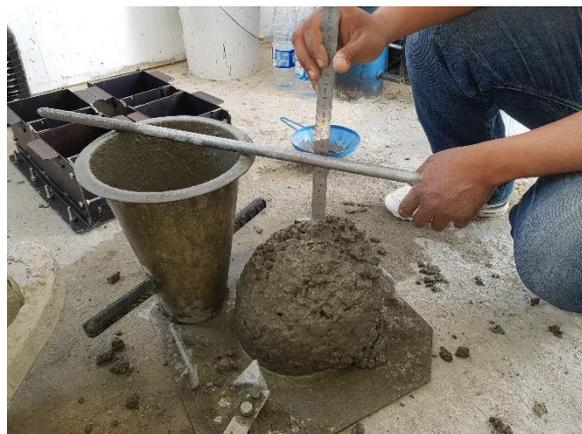
**Figure 28 : Essai D'affaissement cône d'Abrams**
