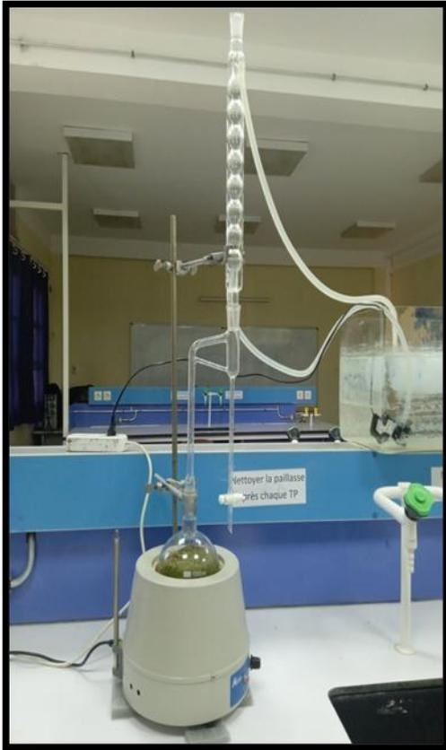
**Figure 18 :** Extraction par cleavenger
