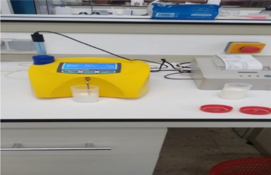
**Figure 10.** Analyseur du lait "Lactoscan® SAP"
