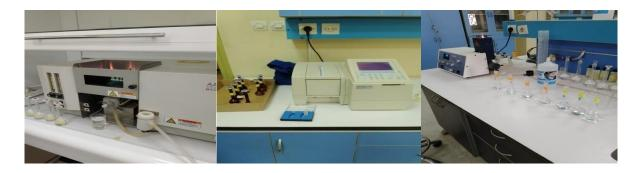
**Figure 13 :** Photo appareil d'absorbance atomique, colorimétrie. photomètre à flamme (Photos originales 2024).
