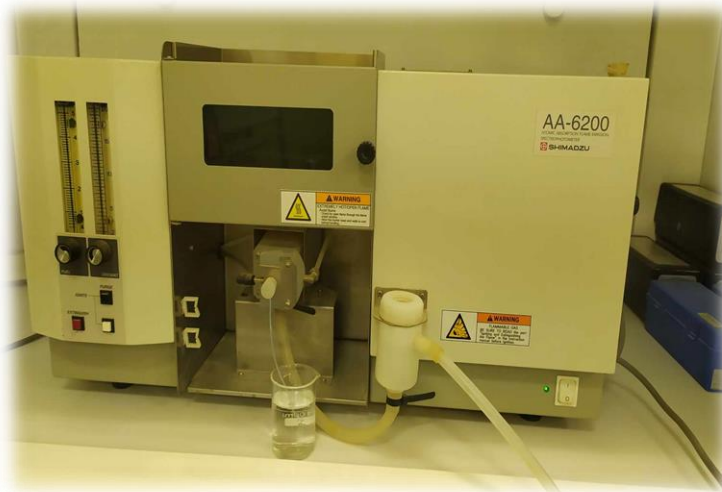
Photo15 : Atomique Absorption flamme Emission Spectrophotomètre ( photo originale)
