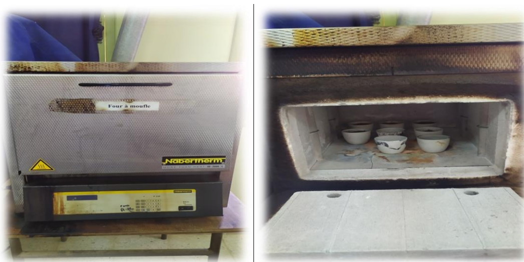
Photo 09 : Les échantillons après la calcination (photo original)
