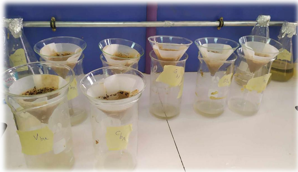
Photo17 : l'extrait du sol après la filtration (photo originale)
