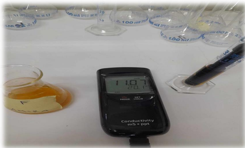
Photo 07 : Détermination de la CE (photo original)
