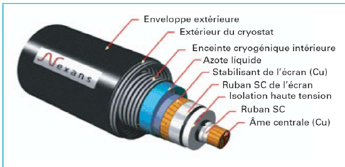
**Figure I.18 :** Coupe du câble supraconducteur Nexans (138 kV / 2400 A ; 600 m) du projet Long Island (USA) [25].
