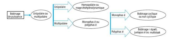
Figure II.33 : Les critères sur les Bobinages
