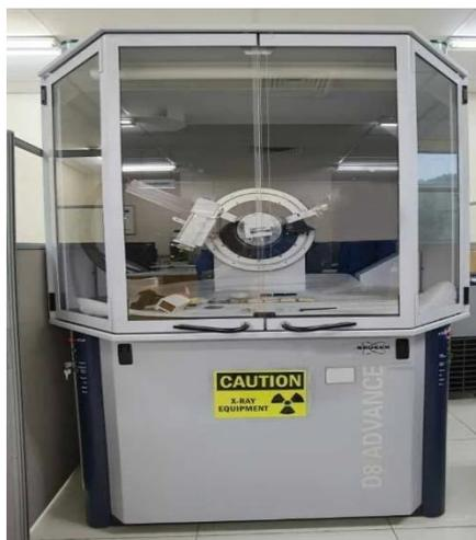
Figure II.12 : Diffractomètre de type (BRUKER-AXS type D8)
