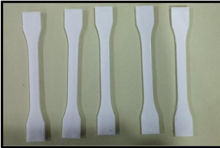
Figure15 : Epreuve fabrique par imprimant 3D (FDM)
