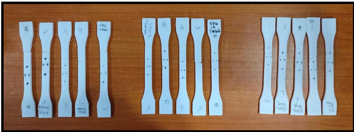
Figure22 : Rupture par traction des éprouvettes
