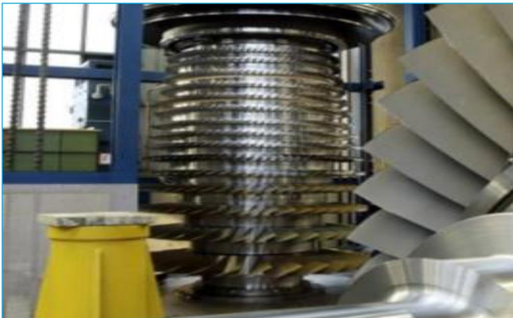
*Figure I.11* : Compresseur de turbine à gaz (15 étages).
