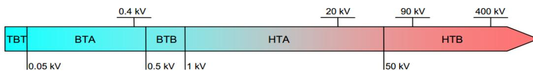
Figure 1.6. La différence niveaux de tension normalisés [DJA 08]
