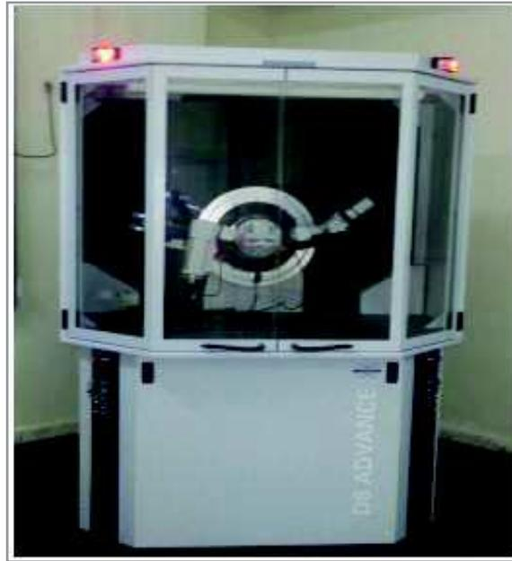
Figure IV. 4: Diffractomètre de type Bruker D8 Advance.
