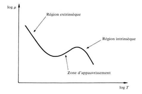
**Figure I.7.** Variation de la résistivité ρ dans un semi-conducteur extrinsèque en fonction de la température
