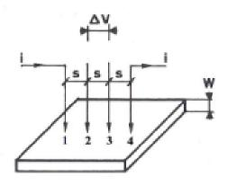
Figure II.7. Principe de la détermination de La résistivité par la méthode de 4 pointes
