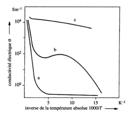
**Figure I.8.** Conductivité electrique d'un semiconducteur en fonction de la temperature : influence des impuretés (défauts) ; (a) peu d'impuretés ; (b) cas normal ; (c) beaucoup d'impuretés.
