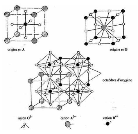
Figure I.1. Structure pérovskite idéale.
