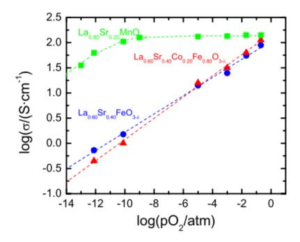
**Figure.I.11.** Courbes de  $\log (\sigma)$  en fonction de  $\log (pO2)$  pour LSM, LST et LSCF
