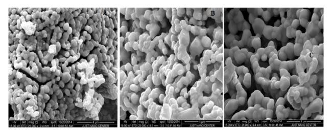
**Figure III.15.** Images de microscopie électroniques à balayage des poudres  $LaCr_{1-x}Zn_xO_3$ : (A) x=0; (B)x=0.2; (C)x=0.3.
