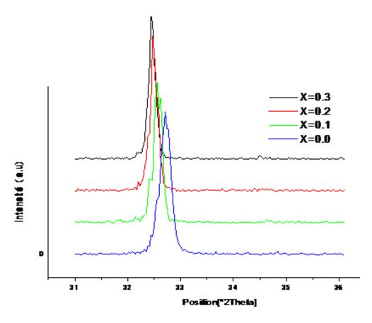
**Figure III.11.**: Diffractogrammes des pics principales des oxydes pérovskite LaCr<sub>x</sub>Zn<sub>1-x</sub>O<sub>3</sub>
