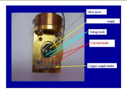
**Figure IV.4.** Photo du porte-échantillon et les connexions électriques.
