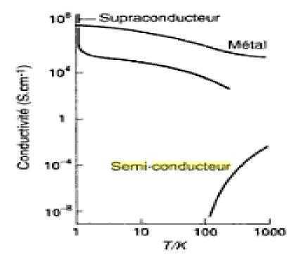
**Figure I.6.** La variation de la conductivité électrique d'une substance avec la température.
