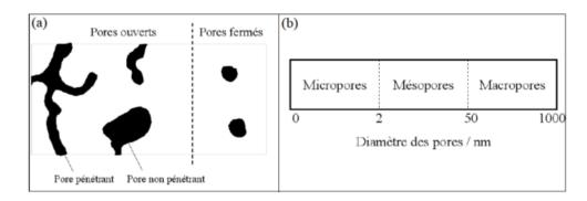
**Figure II.5**: (a) Shematisation des différents types de pores, (b) Nomenclature relative à la taille des pores [21].
