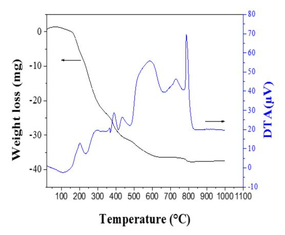
Figure III.7. Courbe ATG/ATD du précurseur LaCr<sub>0.8</sub>Zn<sub>0.2</sub>O<sub>3</sub>.
