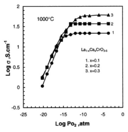
**Figure.I.10.** Conductivté isotherme à  $1000^{\circ}$ C pour les trois différentes compositions :  $x = 0.1, 0.2, \text{ et } 0.3 \text{ dans } \text{La}_{1-x}\text{Ca}_x\text{CrO}_3$  [88]
