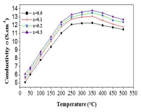
**Figure IV.6.** Evolution de la conductivité électrique de  $LaCr_{1-x}Zn_xO_3$  en fonction de la température et du taux de substitution (x=0-0.3).
