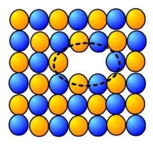
Figure I.2. Défaut de Schottky dans un cristal ionique
