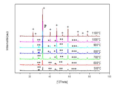
**Figure III.10.** Diffractogrammes des poudres LaCr<sub>0.8</sub>Zn<sub>0.2</sub>O<sub>3</sub>, calcinés à différentes températures :(\*)La<sub>2</sub>CrO<sub>6</sub>, (+)LaCr<sub>0.8</sub>Zn<sub>0.2</sub>O<sub>3</sub>, (P)phase pure à 1100°C.
