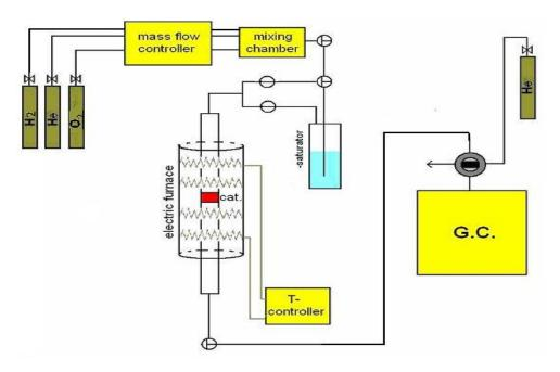
**Figure II.6.**Schéma présentant le montage expérimental de mesure des propriétés catalytiques.
