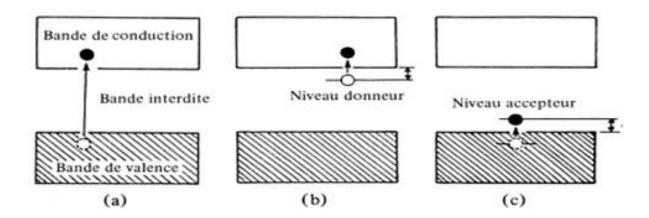
**Figure I.9.** Niveaux énergétiques approximatifs : (a) d'un semi-conducteur intrinsèque ; (b) extrinsèque de type n ; (c) extrinsèque de type p [76].
