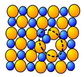
Figure I.3. Défaut de Frenkel dans un cristal ionique
