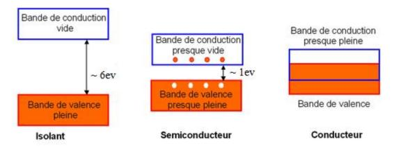
**Figure I.5.** Bandes d'energie de differents materiaux : isolants, semiconducteurs, et conducteurs
