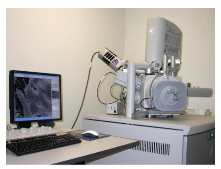
**Figure III.5.** Appareil microscope à balayage de type QUANTA FEG 450
