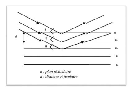
Figure II.3. Principe de la loi de Bragg.
