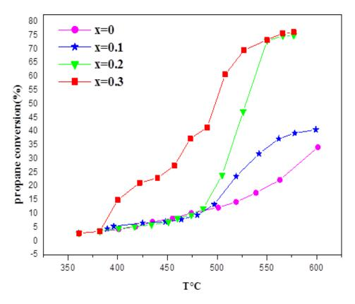
**Figure IV.5**: Conversion du propane  $C_3H_8$  en fonction de la température pour les échantillons  $LaCr_{1-x}Zn_xO_3$  (x=0, x=0-0.3) synthétisés par la méthode solgel.
