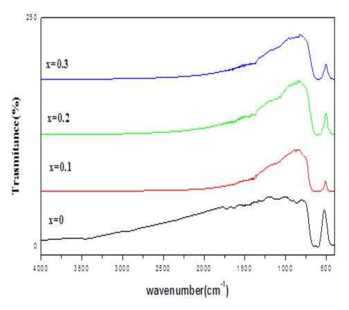
**Figure III.13.**Spectre IR de La $Cr_{1-x}Zn_xO_3$  ( $0 \le x \le 0.3$ ).
