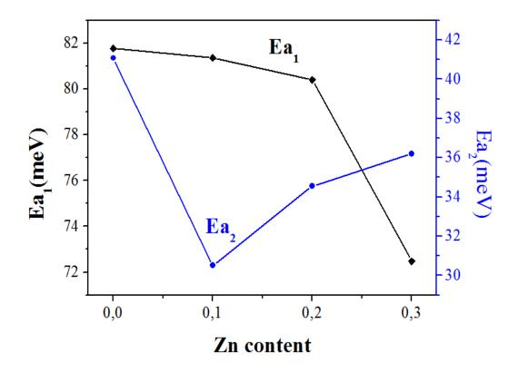
**Figure. IV.8:** Mécanisme de la conduction de LaCr<sub>1-x</sub>Zn<sub>x</sub>O<sub>3</sub> for  $(0 \le x \le 3)$  dans le domaine de température (25-500) °C.
