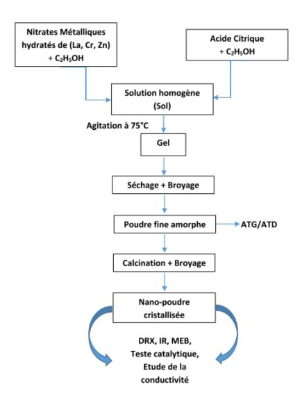
**Figure III.1.** Différentes étapes de la synthèse des poudres de La $Cr_{1-x}Zn_xO_3$  (x=0- 0,3) selon la méthode sol-gel.
