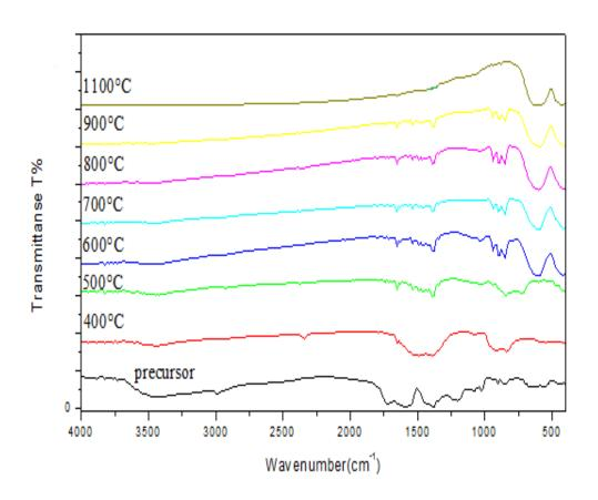
Figure III.14. Spectres IR de LaCr<sub>0.8</sub>Zn<sub>0.2</sub>O<sub>3</sub> calcinées à différentes températures.
