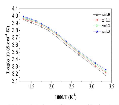
**Figure.IV.7.** Tracés d'Arrhenius pour différentes compositions de LaCr<sub>1-x</sub>Zn<sub>x</sub>O<sub>3</sub>
