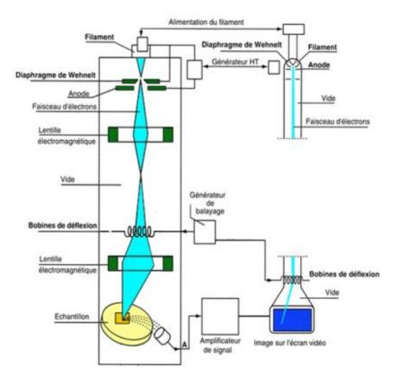
Figure II.4: Représentation schématique du principe de fonctionnement du MEB.
