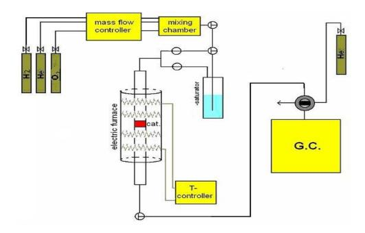
**Figure IV.1.**Schema présentant le montage expérimental de la réaction d'oxydation de C<sub>3</sub>H<sub>8</sub> à la surface des catalyseurs.
