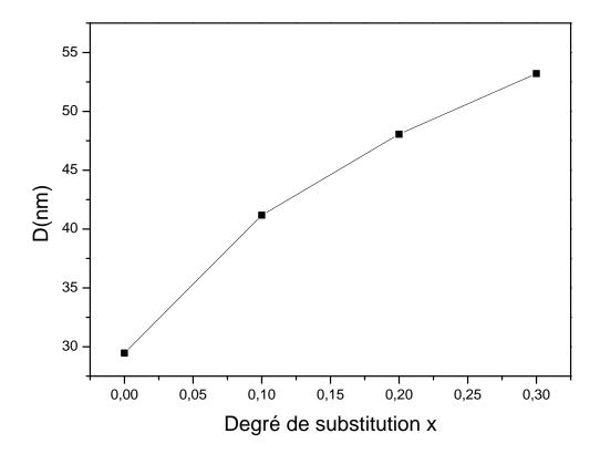
**Figure III.12:** Taille moyenne des cristallites des oxydes  $LaCr_xZn_{1-x}O_3$  en fonction du taux de  $(Zn^{2+})$ .
