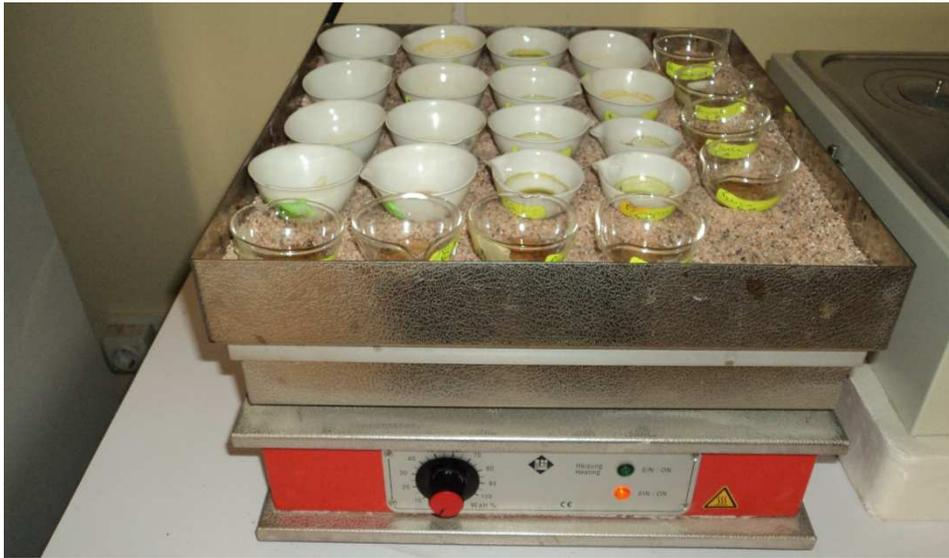
**Figure 17 :** Evaporation des extraits sur bain de sable (photo originale).
