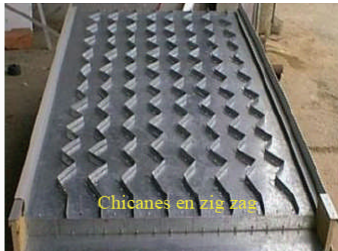
Fig. 2.22 : Disposition et géométrie des chicanes, [11].
